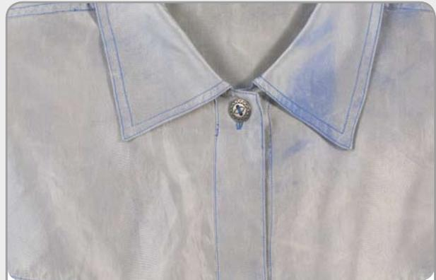
Abbildung\_22: Farbschäden in einer Seidenbluse
