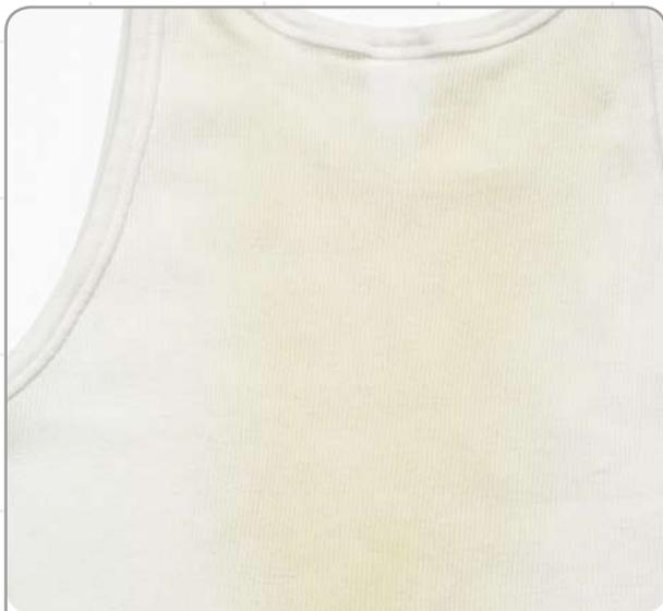
**Abbildung\_34:** Partielle Manganvergilbung in einem Unterhemd
