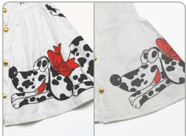
Abbildung\_7: Abriebempfindliches Druckmotiv (links: Original)
