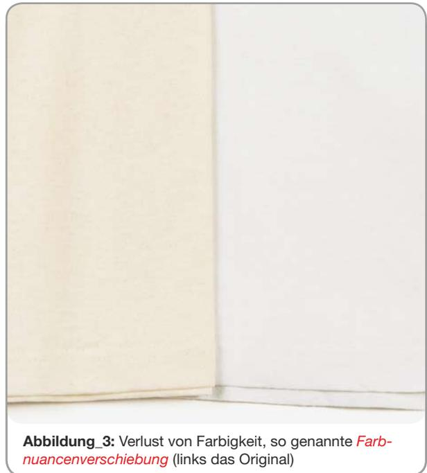
**Abbildung\_3:** Verlust von Farbigkeit, so genannte *Farbtönenverschiebung* (links das Original)
