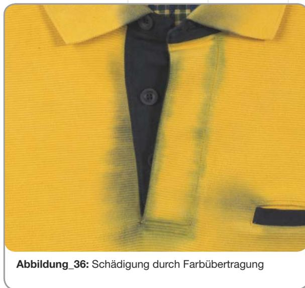
Abbildung\_36: Schädigung durch Farbübertragung
