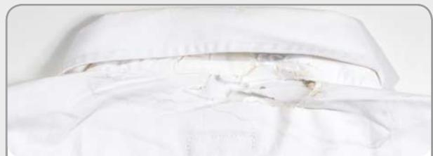
**Abbildung\_37**: Verschleiß (chemische Schäden)
