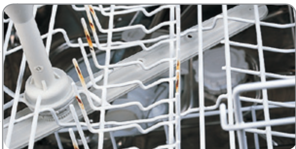
Geschirrkorb mit beschädigter Kunststoffbeschichtung
